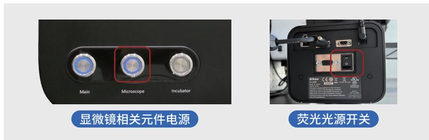
图1.2-2 显微镜相关元件电源开关示意图
