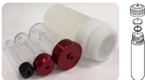
**注: 超速离心管使用时, 必须配套相应的适配器 (adapter)、管塞 (spacer) 等配件使用, 详细信息请参考转头手册。**
